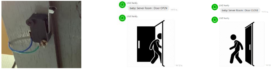
ภาพ 3 Limit Switch และแจ้งเตือนการเข้า – ออกผ่านไลน์
