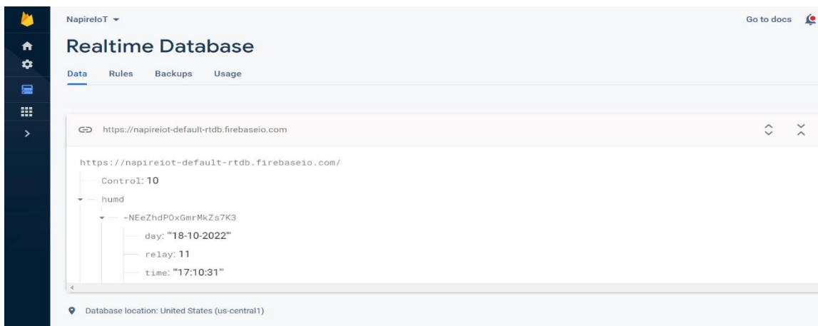
ภาพที่ 5 ฐานข้อมูลบน Firebase ที่อ่านค่ามาจากบอร์ด ESP8266
