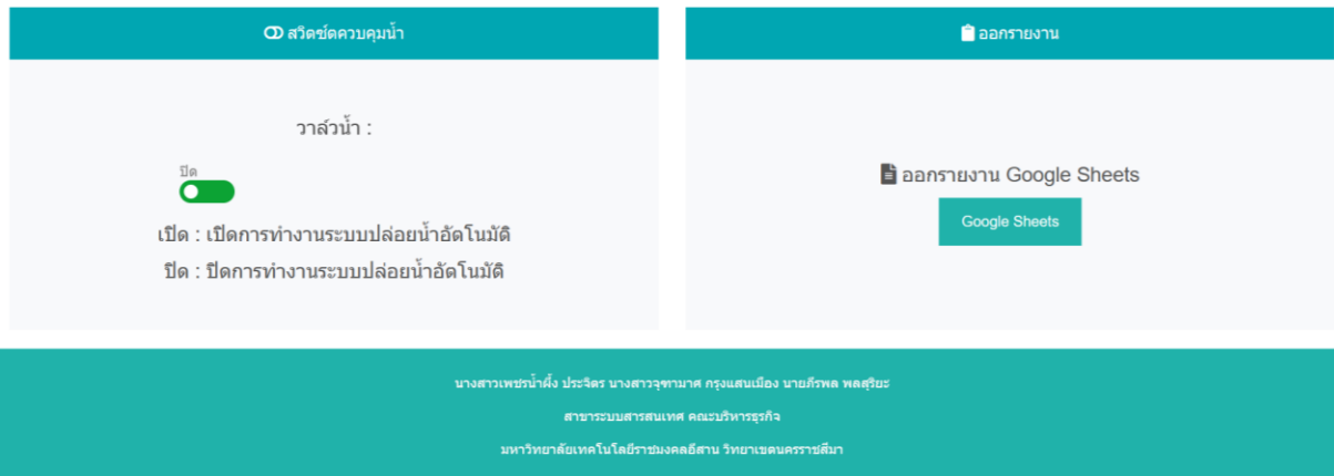
ภาพที่ 4 หน้าเว็บแอปพลิเคชันที่ใช้ควบคุมการเปิด-ปิดวาล์วน้ำ และออกรายงาน Google Sheets
