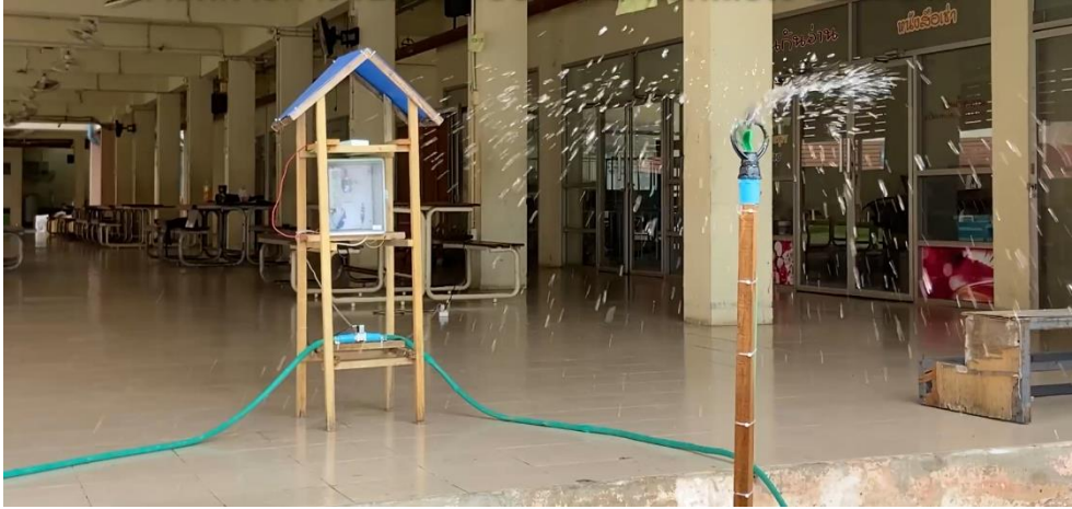
ภาพที่ 7 อุปกรณ์ไอโอทีและสปริงเกอร์รดน้ำ
